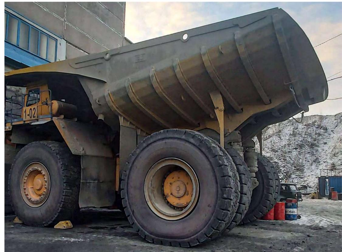
Стандартные кузова производства ООО «Профессионал» позволяют значительно снизить расходы на приобретение самосвалов импортного производства в комплектации с оригинальными кузовами. Данные кузова обеспечивают полное соответствие оригинальной конструкции и по желанию Заказчика оснащаются комплектами футеровочных элементов с учетом специфики пород.
